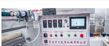
Automatikus berendezések celofánba történő csomagolásához gyógyszergyártásban
