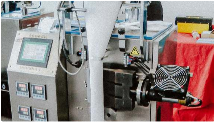
Mesin pengemas otomatis untuk mengemas bubuk dan butiran menjadi bahan filter tas... Pharmaceutical Tablet Press · 11.09.2020 · 1.550K tampilan
