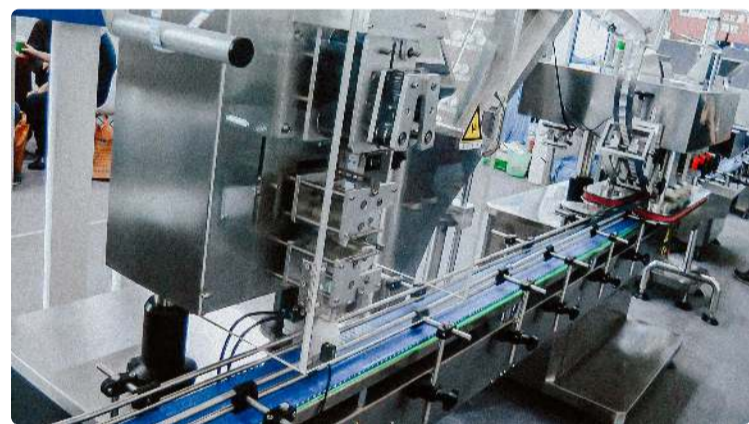
Kemasan bubuk dalam botol plastik dan capping untuk produksi obat Pharmaceutical Tablet Press - 10.09.2020 - 987 tampilan
