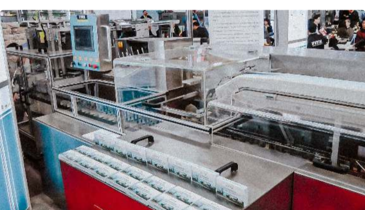
Mesin karton otomatis untuk kemasan lecek dengan tablet dalam kotak karton Pharmaceutical Tablet Press · 09.09.2020 · 997 tampilan
