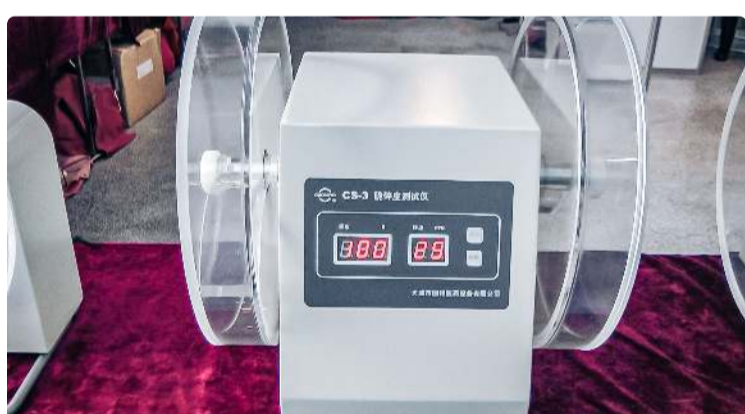
Peralatan otomatis untuk menguji tingkat abrasi tablet dan kapsul di produksi farmasi Aljazair
