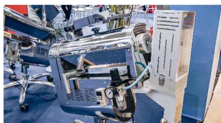
Peralatan otomatis untuk memoles dan menghilangkan debu kapsul gelatin oleh...
