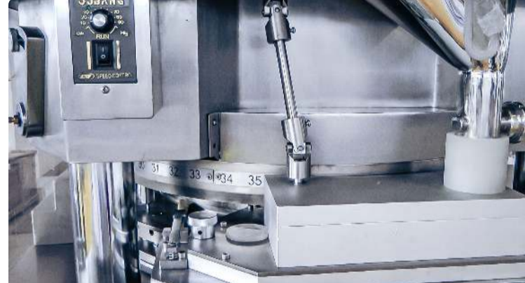
Peralatan otomatis untuk membuat tablet dari butiran dan bubuk dalam produksi farmasi Pharmaceutical Tablet Press · 01.12.2020 · 54.570K tampilan
