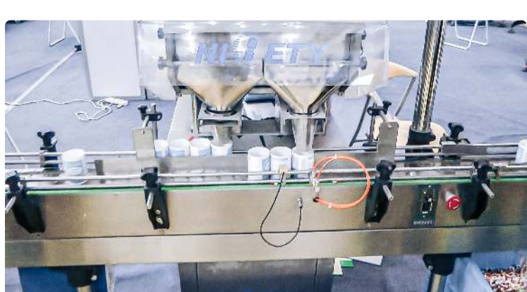
Peralatan otomatis untuk mengisi kapsul gelatin ke dalam botol dalam produksi farmasi Pharmaceutical Tablet Press · 26.11.2020 · 94.541K tampilan
