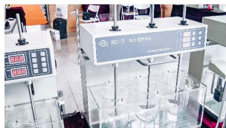
Peralatan otomatis untuk pengujian kualitas tablet dan kapsul dalam produksi farmasi... Pharmaceutical Tablet Press · 09.12.2020 · 79.401K tampilan
