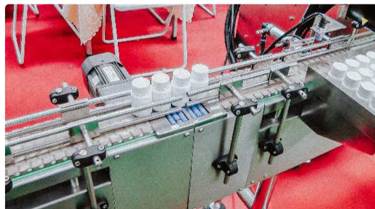
Mesin las induksi membran otomatis di leher botol plastik dengan ban berjalan Kemasan Farmasi • 15.09.2020 • 787 tampilan
