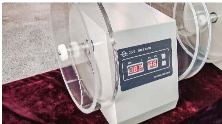
Peralatan pengujian kualitas tablet abrasi laboratorium otomatis dalam produksi farmasi... Pharmaceutical Tablet Press • 09.12.2020 • 77.500K tampilan
