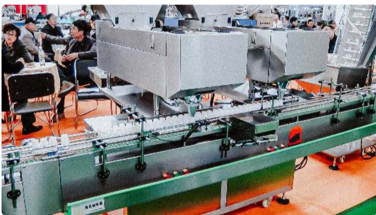
Mesin pengisian otomatis untuk mengisi kapsul gelatin keras ke dalam botol plastik Kemasan Farmasi · 17.09.2020 · 7.800K tampilan
