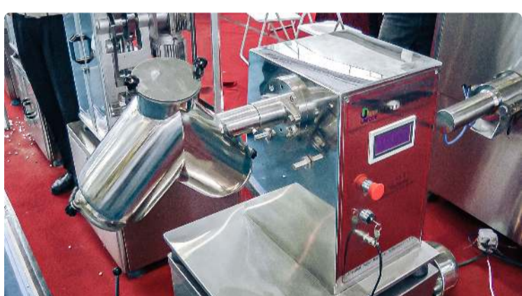
Peralatan otomatis untuk mencampur bubuk dalam mixer dalam produksi farmasi Pharmaceutical Tablet Press • 01.12.2020 • 5.400K tampilan
