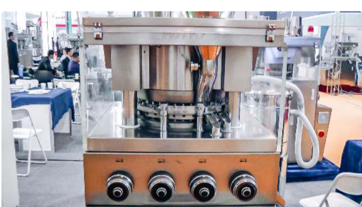
Peralatan otomatis untuk produksi dan pengepresan tablet dalam produksi farmasi Pharmaceutical Tablet Press · 10.12.2020 · 70.410K tampilan
