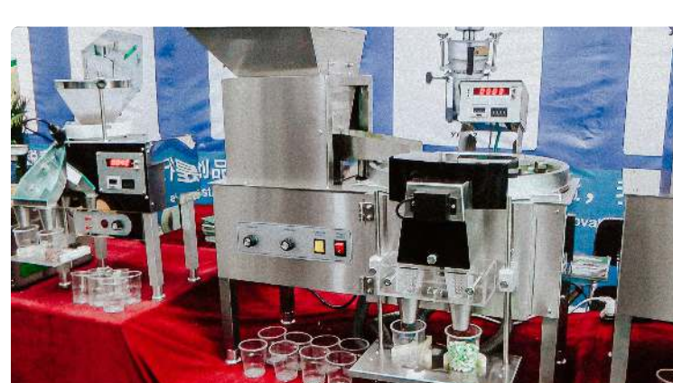
Peralatan untuk menghitung dan mengemas tablet, dragee, pil, kapsul, permen Pharmaceutical Tablet Press · 28.08.2020 · 2.054K tampilan
