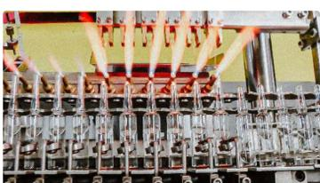
Automātiska stikla ampulu uzpildīšanas un aizvēršanas līnija ar zālēm
