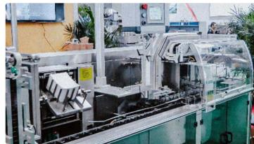
Mesin karton automatik untuk membungkus lepuh dan tiub plastik ke dalam kotak
