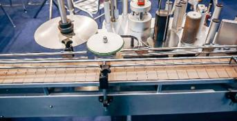
Peralatan automatik untuk membran aluminium induksi pada botol plastik leher
