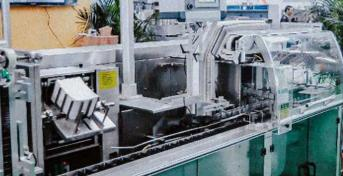
Mesin karton automatik untuk membungkus lepuh dan tiub plastik ke dalam kotak
