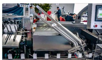
Peralatan automatik untuk membungkus lepuh dengan kapsul dalam kotak kadbod Akhbar Tablet Farmaseutikal · 23.11.2020 · 77.410K pandangan
