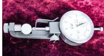
Peralatan automatik untuk ujian diameter tablet dalam pengeluaran farmaseutikal
