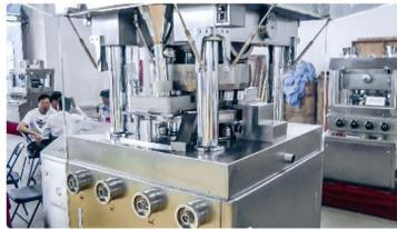
Peralatan automatik untuk pembuatan tablet tablet dalam pengeluaran farmaseutikal
