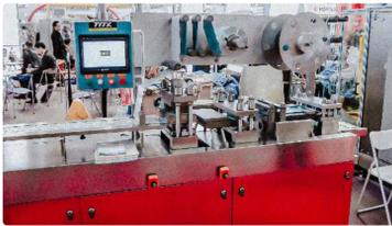
Mesin lepuh automatik untuk mengisi cecair ke dalam ampul plastik lembut
