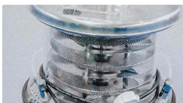
Mesin getaran untuk penyingkiran habuk dari tablet dan penggilap selepas pengeluaran tablet
