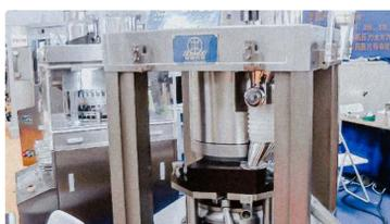
Mesin tablet putar automatik model baru untuk pengeluaran pelbagai bentuk tablet
