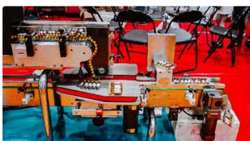
Peralatan automatik untuk membungkus botol penisilin ke dalam plastik lepuh
