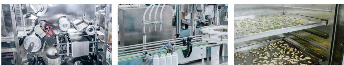
**Peralatan automatik untuk membungkus kapsul gelatin ke dalam lepuh dalam...**
