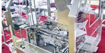
Peralatan kadbod untuk pembungkusan dalam kadbod lepuh dengan tablet dalam...
