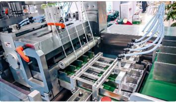
Peralatan automatik untuk pembungkusan dalam filem selofan kotak perubatan
