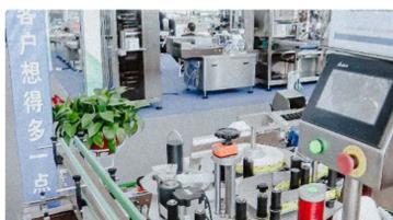
Peralatan pelabelan automatik untuk pelabelan label pelekat sendiri pada botol
