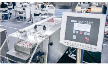
Peralatan automatik untuk kapsul gelatin menghitung dan mengisi botol dalam...
