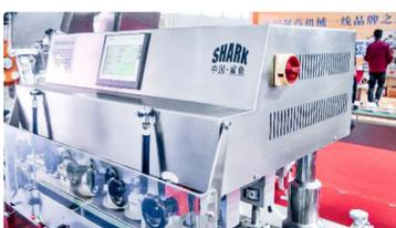
Peralatan automatik untuk mengacaukan penutup plastik pada botol plastik
