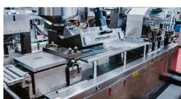
Peralatan farmasi untuk pembungkusan automatik tablet dan kapsul dengan ubat dala...
