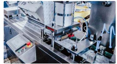
Peralatan lepuh automatik untuk pembungkusan tablet dan kapsul gelatin
