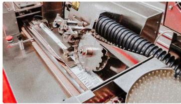
Mesin pembungkusan automatik untuk menyusun ampul kaca dalam lepuh plastik
