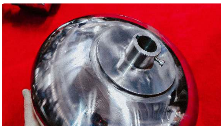
Strøk for påføring av tablett skallet for farmasøytisk laboratorieproduksjon Farmsøytisk emballasje · 24.09.2020 · 14.400K utsikt
