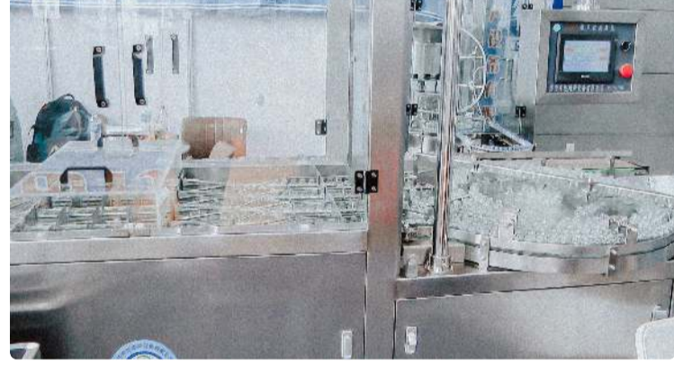
Automatisk maskin for vasking og sterilisering av penicillinflasker av glass Farmasøytisk tablettpresse · 01.09.2020 · 1.555K utsikt
