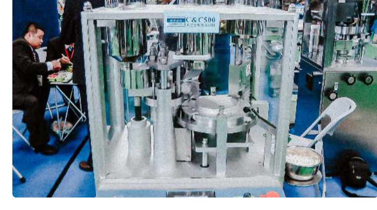
Farmasøytisk utstyr for å fylle faste gelatinkapsler med mikrogranuler Farmasøytisk emballasje · 18.09.2020 · 18.905K utsikt
