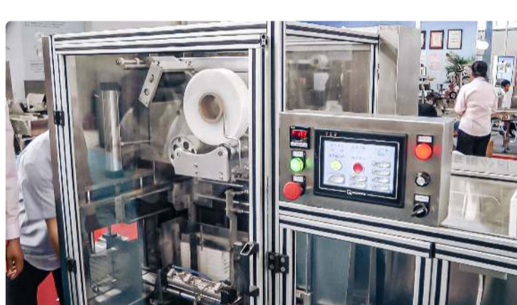
Automatisk utstyr cellofanemballasje i farmasøytisk produksjon
