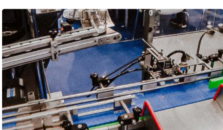
Høyhastighets automatisk påfyllingslinje med gelatinkapsler i plastflasker med silicogel-puter
