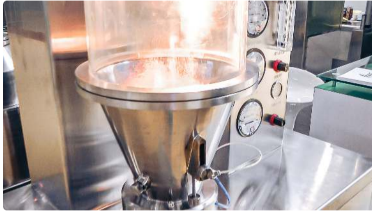
Automatisk utstyr for tørking og granulering av pulver i farmasøytisk produksjon av fluidisert... Farmasøytisk tablettpresse · 30.11.2020 · 95.450K utsikt
