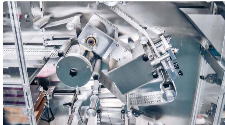
Automatisk utstyr for emballasje av PVC / ALU-blikerkapsler i farmasøytisk produksjon Farmasøytisk tablettresse · 02.12.2020 · 110,740K utsikt
