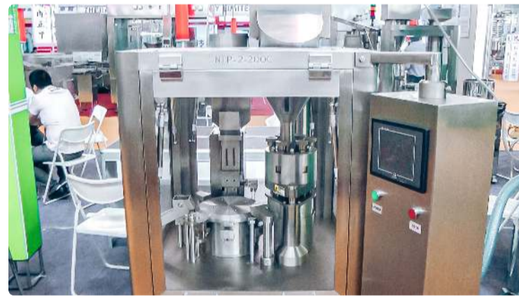
Automatisk utstyr for å fylle harde gelatinkapsler med pulver i farmasøytisk produksjon
