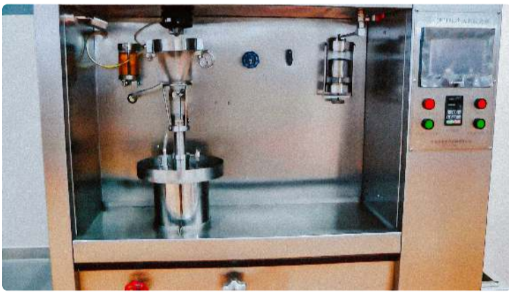
Utstyr for produksjon av gelkapsler med olje i produksjon av medisiner
