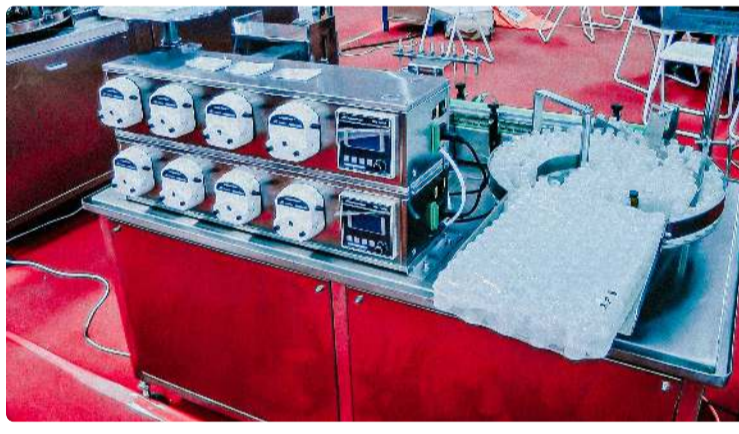
Automatisk væskefyllingsmaskin for glassflasker med peristaltiske pumper
