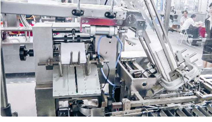
Automatisk blisterpakkingsutstyr i pappesker i farmasøytisk produksjon Belgia Farmasøytisk tablettresse · 07.12.2020 · 79.700K utsikt
