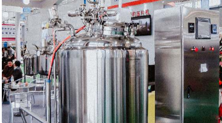
Farmasøytisk tank med oppvarming og omrører for fremstilling av løsninger og geler... Farmasøytisk emballasje · 17.09.2020 · 17.854K utsikt
