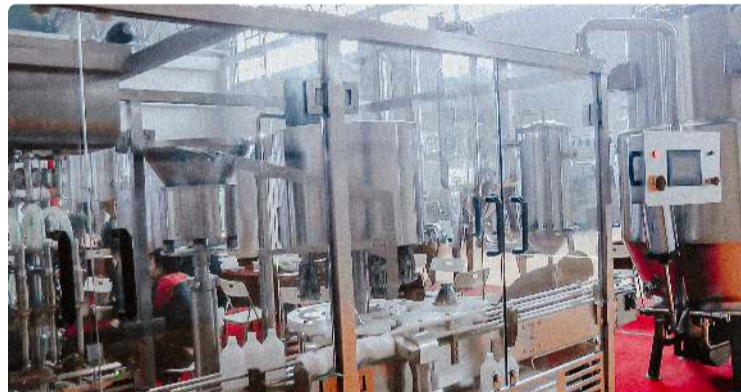
Automatisk tappemaskin for store plastflasker og skruelukk Farmasøytisk emballasje · 21.09.2020 · 18.700K utsikt
