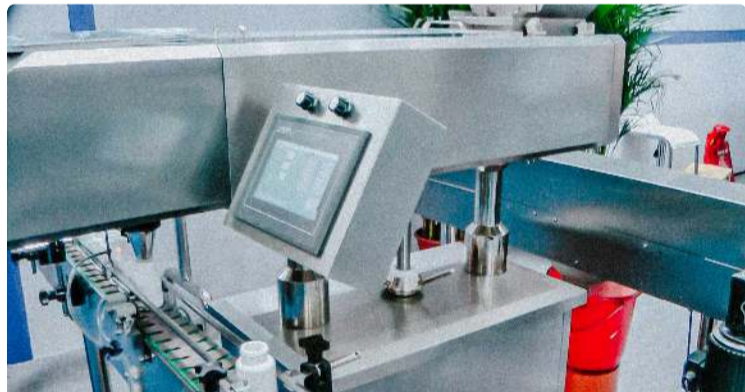
Emballasje- og tellemaskin for harde gelatinkapsler og tabletter i plastflasker Farmasøytisk tablettpresse · 04.09.2020 · 1.505K utsikt
