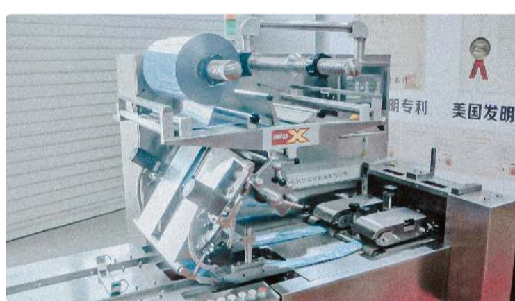
Automatisk emballasjemaskin for å pakke blemmer med piller i plastpose Farmasøytisk tablettresse · 04.09.2020 · 2.508 kutsikt
