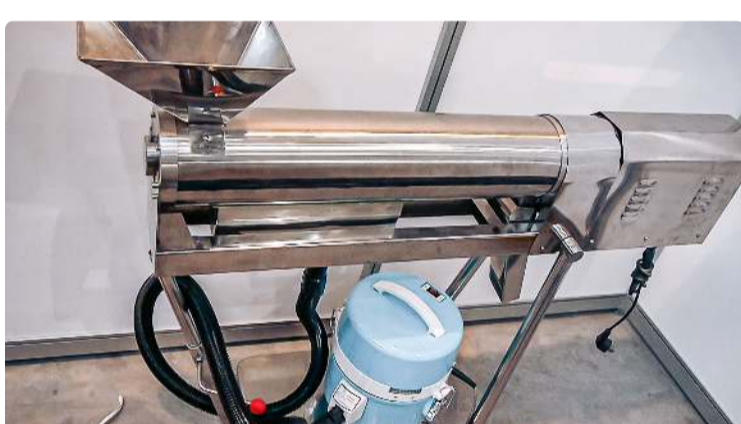
Automatisk utstyr for rengjøring og polering av faste gelatinekapsler Farmasøytisk tablettresse · 04.11.2020 · 45.400K utsikt
