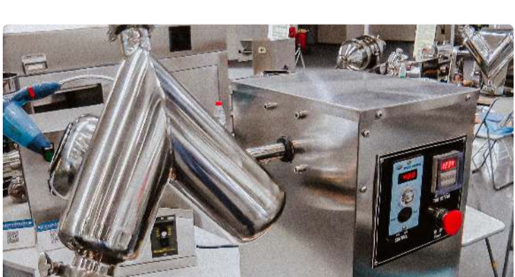
V-mikser for blanding av pulver i farmasøytisk laboratorium og blanding av produksjon Farmasøytisk tablettpresse · 03.09.2020 · 2.057K utsikt
