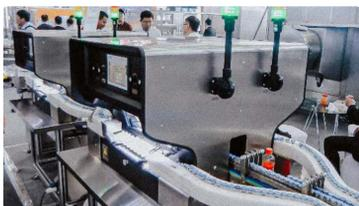
Sistema automático de control visual de la calidad de las botellas de penicilina líquida.
