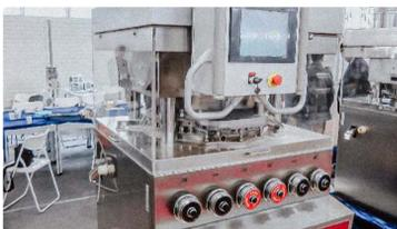
Prensa de tabletas rotatoria automática de alta velocidad para prensado de polvo
