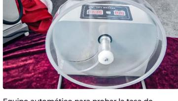
**Equipo automático para probar la tasa de abrasión de tabletas y cápsulas en la producció...**
