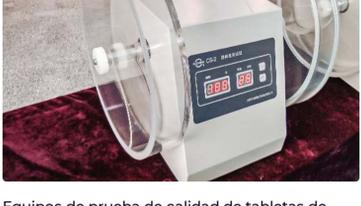
**Equipos de prueba de calidad de tabletas de abrasión de laboratorio automáticos en la...**
