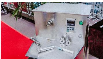
Pulido automático de moldes y punzonadora para prensa rotativa automática de tabletas
