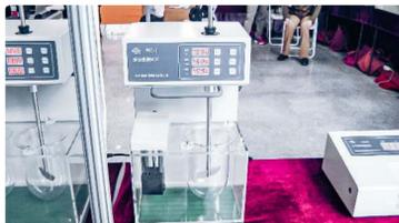
Equipo automático de prueba de velocidad de pellets en la producción farmacéutica
