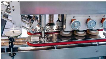
Equipo automático para el conteo y llenado de tabletas en botellas de plástico USA
