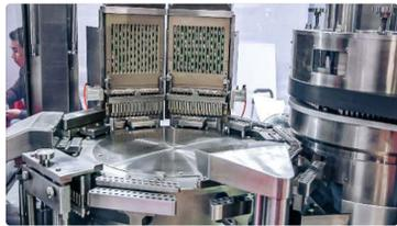
Equipo automático para el llenado de cápsulas de gelatina dura con polvo USA
