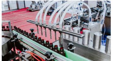
Máquina automática de llenado y tapado para botellas de plástico para medicamentos
