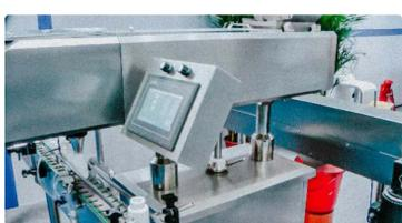
Máquina de envasado y recuento de cápsulas y comprimidos de gelatina dura en botellas de...
