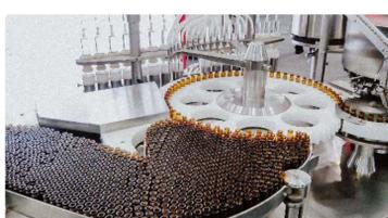
Máquina de alta velocidad para embotellar y tapar botellas de penicilina con tapón de...
