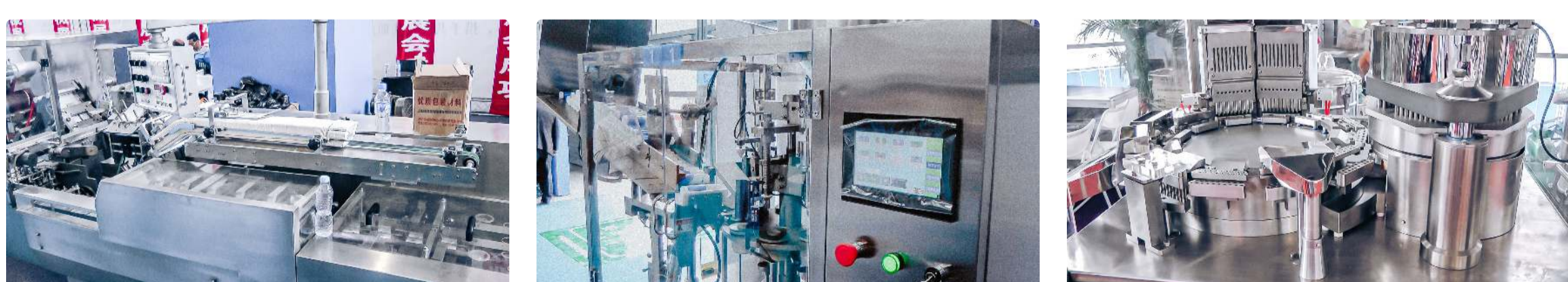
Automatisk blisterförpackningsutrustning i kartonger i läkemedelsproduktion Automatisk maskin för fyllning och tätning av krämdoseringen i plaströr Automatisk utrustning för pulverfyllning av gelatinkapslar i läkemedelsproduktion
